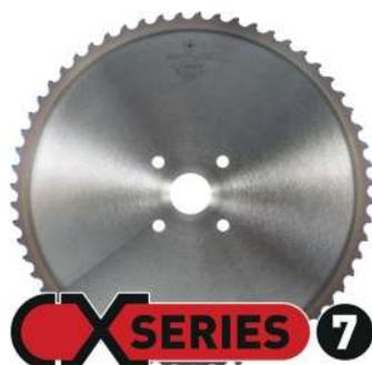
CX 7 es una sierra circular con punta de Cermet, con recubrimiento de PVD, utilizada para cortar acero al carbono (contenido de carbono  $< 0.60\%$ ) con una resistencia a la tracción de baja a media hasta 750 N/mm<sup>2</sup>. El mejor rendimiento de la hoja se consigue al cortar materiales de menor resistencia a la tensión. En muchas aplicaciones, se puede lograr una vida útil de la hoja de 50 m<sup>2</sup> y más.
