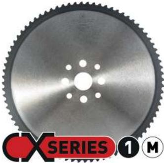
La Sierra Circular CX 1-M con punta de carburo y recubrimiento de PVD, ha sido desarrollada para cortar acero al carbono sólido (contenido de carbono < 0.60%) con una resistencia a la tensión media entre 500 y 900 N/mm<sup>2</sup> a velocidades de producción muy altas.
