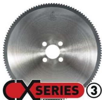
El disco sierra CX3 ha sido desarrollado para cortar tubos en equipos de corte automatico de alto rendimiento, a velocidades mas altas que las posibles con HSS. Los resultados se aprecian utilizando estas sierras con equipos capaces de controlar y variar verazmente la velocidad de avance. Para mayor estabilidad esta sierra tiene puntas reforzadas a partir de pasos > 9mm.
