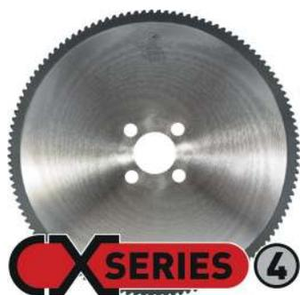
El alto contenido de nickel en los aceros austeniticos dificulta su corte con discos sierras HSS. El disco CX4 con recubrimiento PVD y un diente de carburo con geometria especifica provee un corte con una calidad de superficie perfecta y exento de rebaba.
